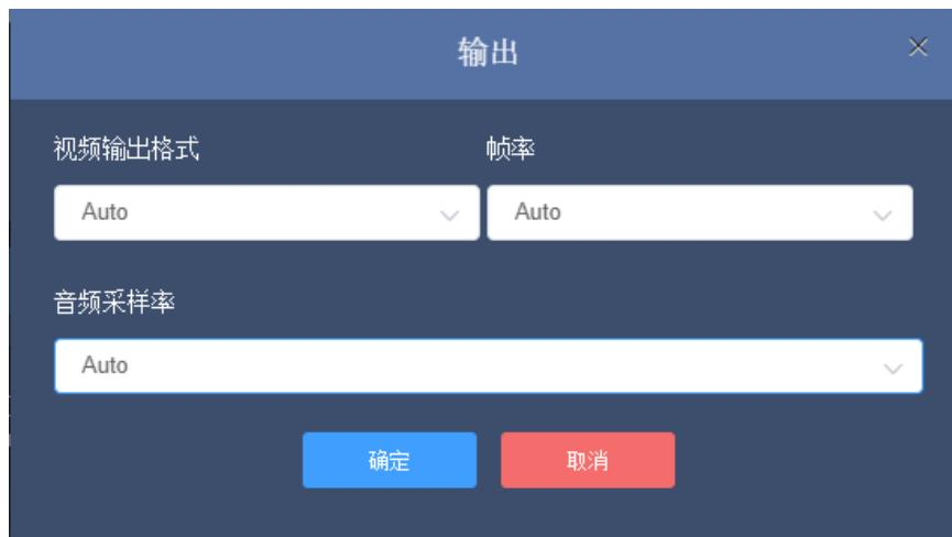
⚠ 注意：N40 在解码输出 4K P25/30 时采用 4:2:2 编码，如视频源 4K P25/30 格式采用 4:2:0 编码，解码输出时将以 4:2:0 方式自动适配输出 4K P50/60 格式。
