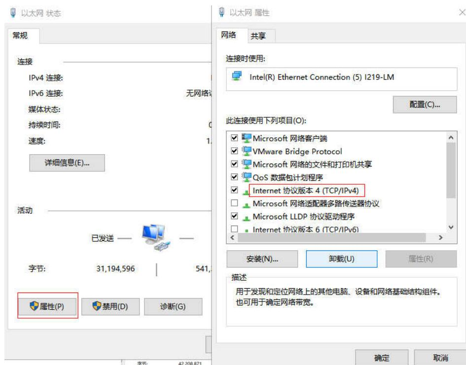
4) 计算机默认为“自动获得 IP 地址”，这时需要选择“使用下面的 IP 地址”，并手动输入 192.168.1.\*这个 IP 地址和子网掩码，点击“确定”。
